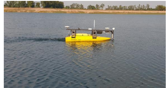
รูปที่ 9 เรือสำรวจขณะทำการเก็บข้อมูลพื้นผิวใต้ท้องน้ำ
