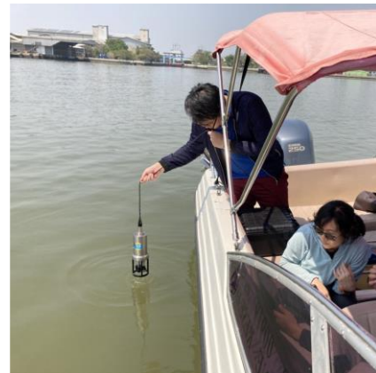
รูปที่ 6 ตัวอย่างการสำรวจด้วยอุปกรณ์ Multi-parameter CTD
