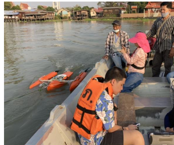
รูปที่ 9 ตัวอย่างการสำรวจด้วยอุปกรณ์ ADCP ตรวจวัดปริมาณน้ำท่า ณ บริเวณปากคลองประปา
