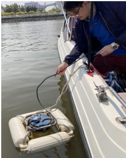
รูปที่ 6 ตัวอย่างการสำรวจด้วยอุปกรณ์เครื่องวัดความเร็วกระแสไฟฟ้าตามความลึก
