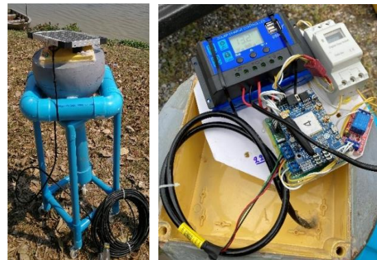
รูปที่ 2 ภายในและภายนอกของระบบตรวจวัดระดับน้ำขนาดเล็กแบบลอยน้ำ
