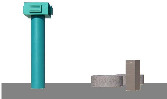
รูปที่ 3 แบบจำลองต้นแบบท่ออากาศ, Manhole, และ ตู้ควบคุมไฟฟ้า ตามการออกแบบของวิศวกร [5]
