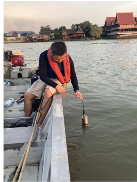
รูปที่ 8 ตัวอย่างการสำรวจด้วยอุปกรณ์ Multi-parameter CTD ณ บริเวณปากคลองประปา
